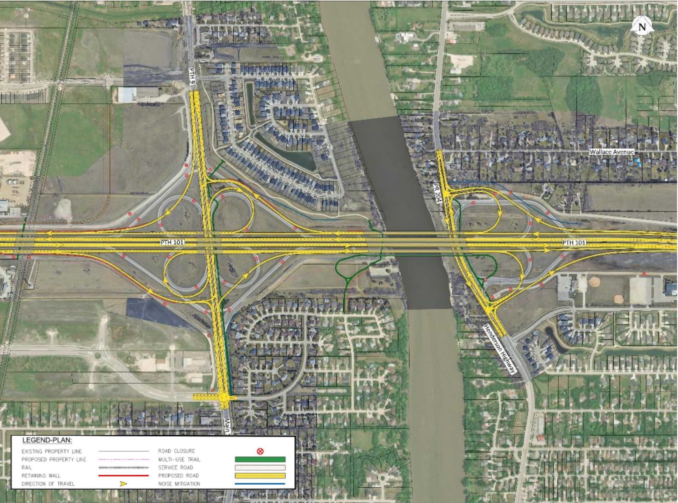
Figure 5-7 : Échangeur en trèfle partiel de la RPGC 9 et échangeur en trèfle partiel de la RPS 204
