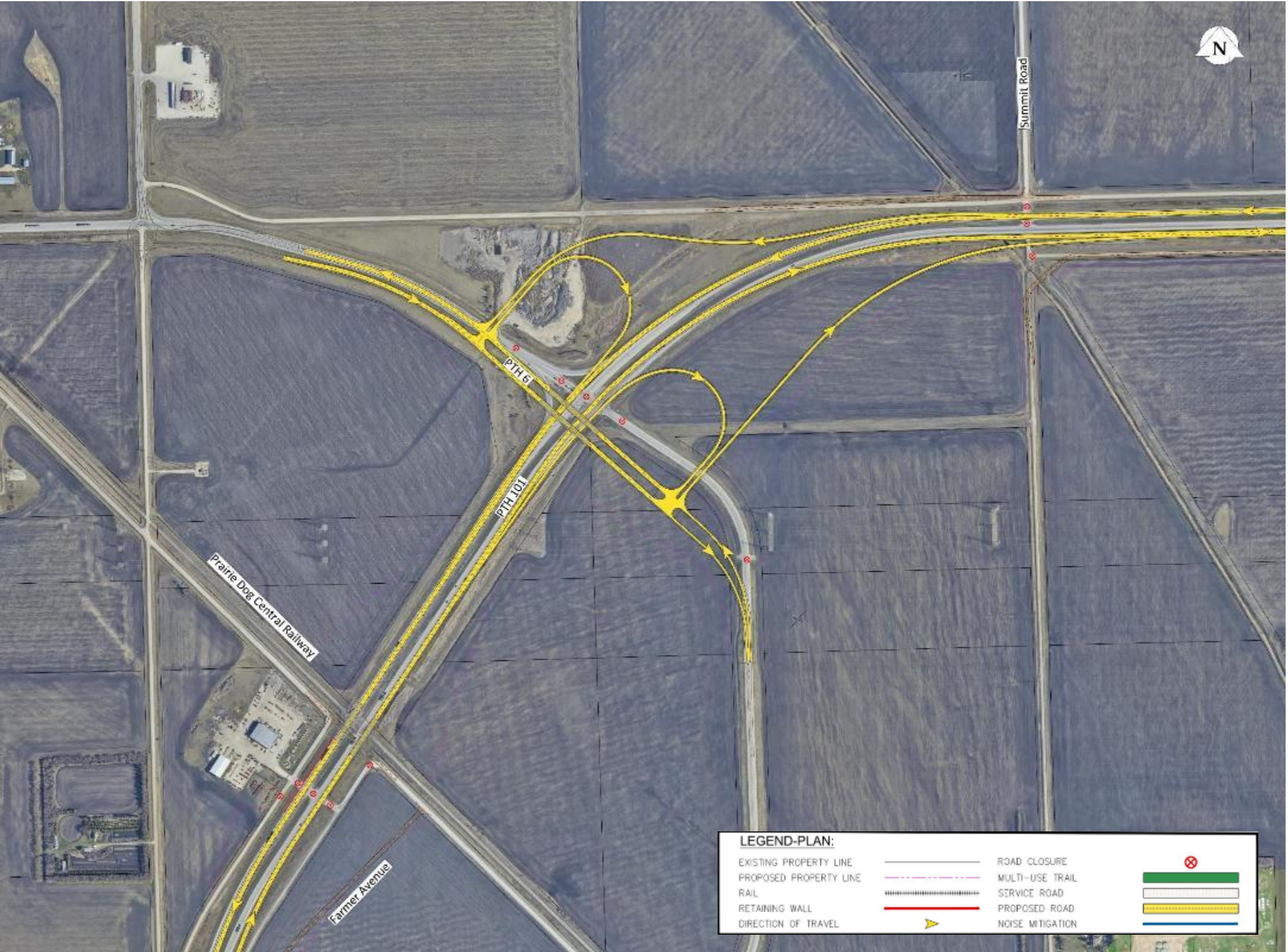
Figure 5-3 : Échangeur en trèfle partiel de la RPGC 6 et passage supérieur ferroviaire
